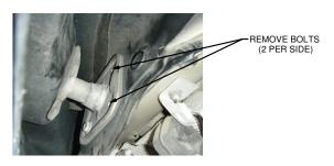
BUMPER BEAM BOLT REMOVAL DIAGRAM (DRIVER SIDE SHOWN)
