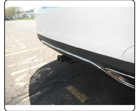
GROSS LOAD CAPACITY WHEN USED AS A WEIGHT CARRYING HITCH: 2,000 LBS. TRAILER WEIGHT & 200 LBS. TONGUE WEIGHT.
