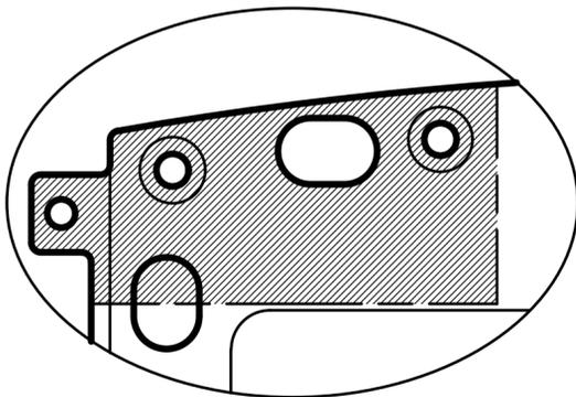
TRIM PLASTIC PANEL ON DRIVER SIDE FOR ADEQUATE HITCH CLEARANCE
