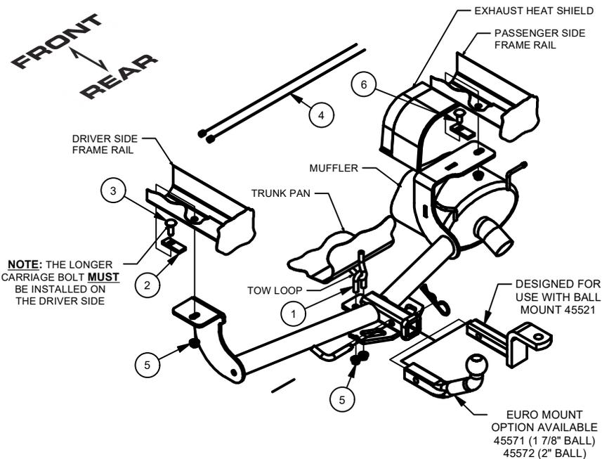
**NOTE:** THE LONGER CARRIAGE BOLT **MUST** BE INSTALLED ON THE DRIVER SIDE
