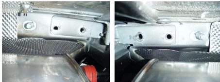
PASSENGER SIDE HEAT SHIELD TRIMMING
