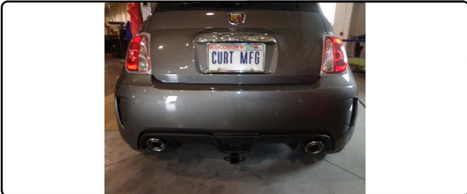
GROSS LOAD CAPACITY WHEN USED AS A WEIGHT CARRYING HITCH: 2,000 LBS. TRAILER WEIGHT & 200 LBS. TONGUE WEIGHT.
