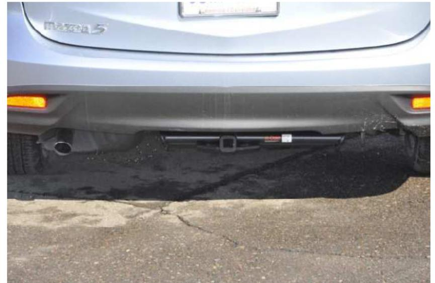
GROSS LOAD CAPACITY WHEN USED AS A WEIGHT CARRYING HITCH: 2,000 LBS. TRAILER WEIGHT & 200 LBS. TONGUE WEIGHT.
